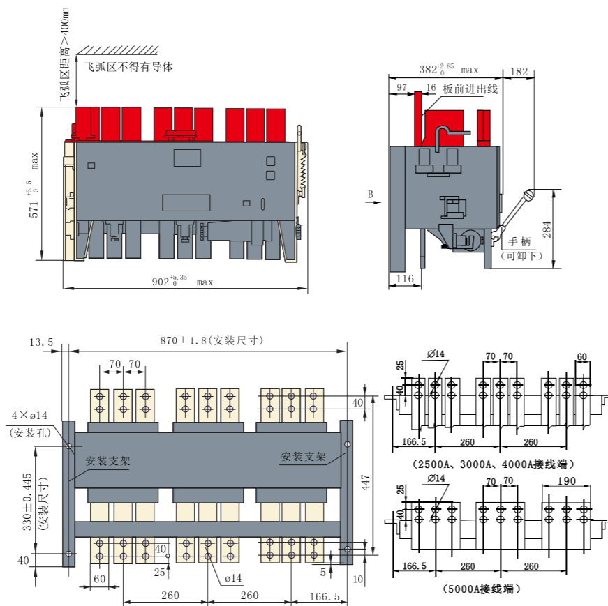
B相安装尺寸及主电路板前接线端尺寸
